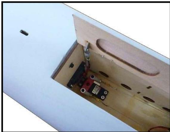
**SERVO GEAR INSTALLATION**
