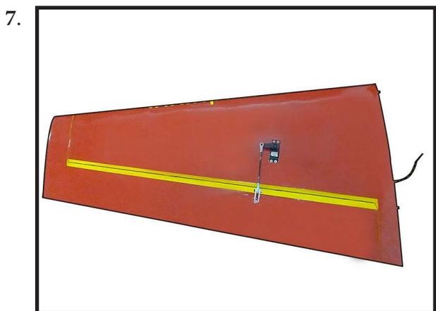
**INSTALL HINGE FOR STABILIZER AND ELEVATOR**
