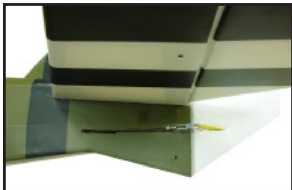
**INSTALL BRACING WIRE AND METAL BRACKET AT THE TAIL.**
