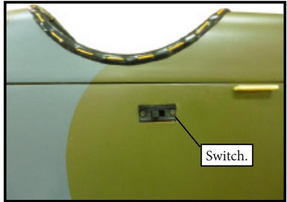
**INSTALLING THE ENGINE SWITCH.**
