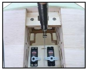
RUDDER PUSHROD INSTALLATION
