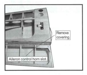
☐ 4) Insert aileron control horn to the aileron.
